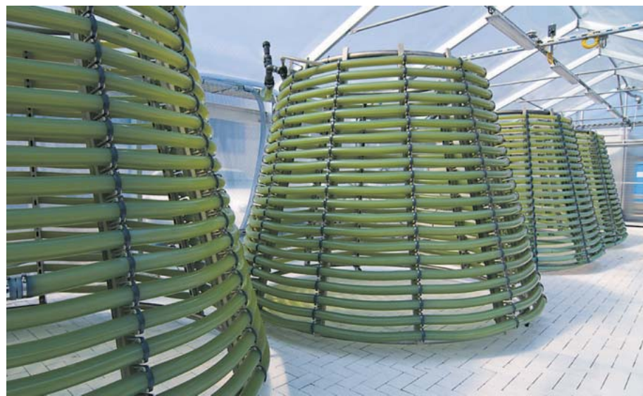
Mit Tannenbaum-Reaktoren kultiviert man in Köthen Mikroalgen. Foto Hochschule Anhalt
