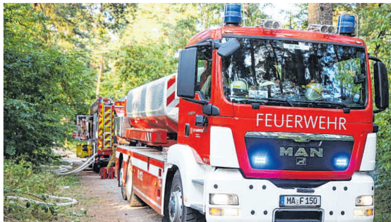
Startklar: Ein Spezialfahrzeug mit einem Absetzbehälter, in dem ein 8000-Liter-Wassertank eingebaut ist – hier bei einem Einsatz im Käfertaler Wald. BILD: PROSSWITZ
